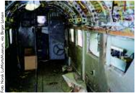
Vista do interior do nº 6304, no início do processo de restauro, com a remoção de todos os estofos da cabine, sendo visível o estado de deterioração em que se encontravam os materiais
