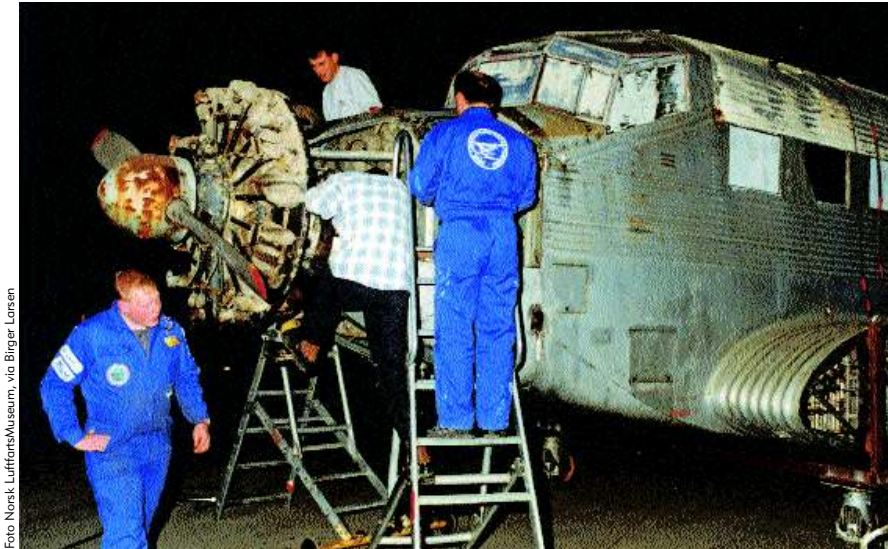
Início dos trabalhos de recuperação do avião, em 1995, em Bodø, na Noruega. Na imagem, a desmontagem de um dos motores
